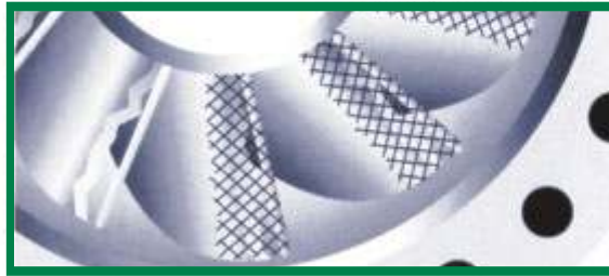
La malla de metal colocada sobre las aspas dañadas reconstruye y refuerza el área de reparación.
