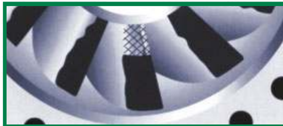
Recubra la malla de metal con epóxico y alise el acabado.
