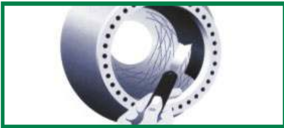
La pasta epóxica se emplea para reconstruir las áreas desgastadas en la voluta.
