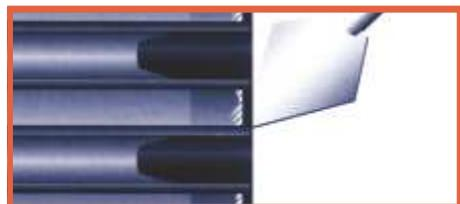
Reconstruya la superficie dañada con el compuesto Wear Resistant Putty.
