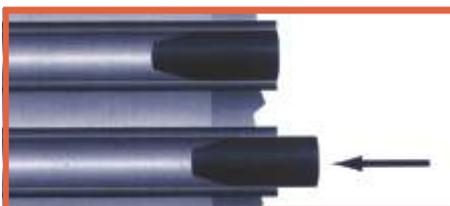
Instale los tapones al extremo del tubo, cuando este sobresalga de la plancha.
