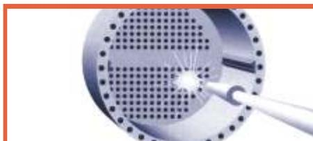
Arene la plancha de tubos después de instalar los tapones.
