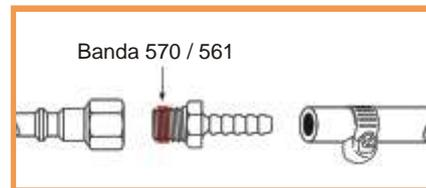
1. Si es necesario, rocíe las cuerdas del adaptador con Activador T de Loctite®. Deje que sequen.
