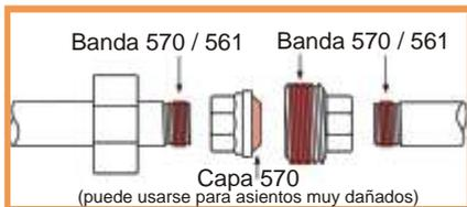
1. Desarme y rocíe todos los componentes con Activador T de Loctite®. Deje que sequen.
